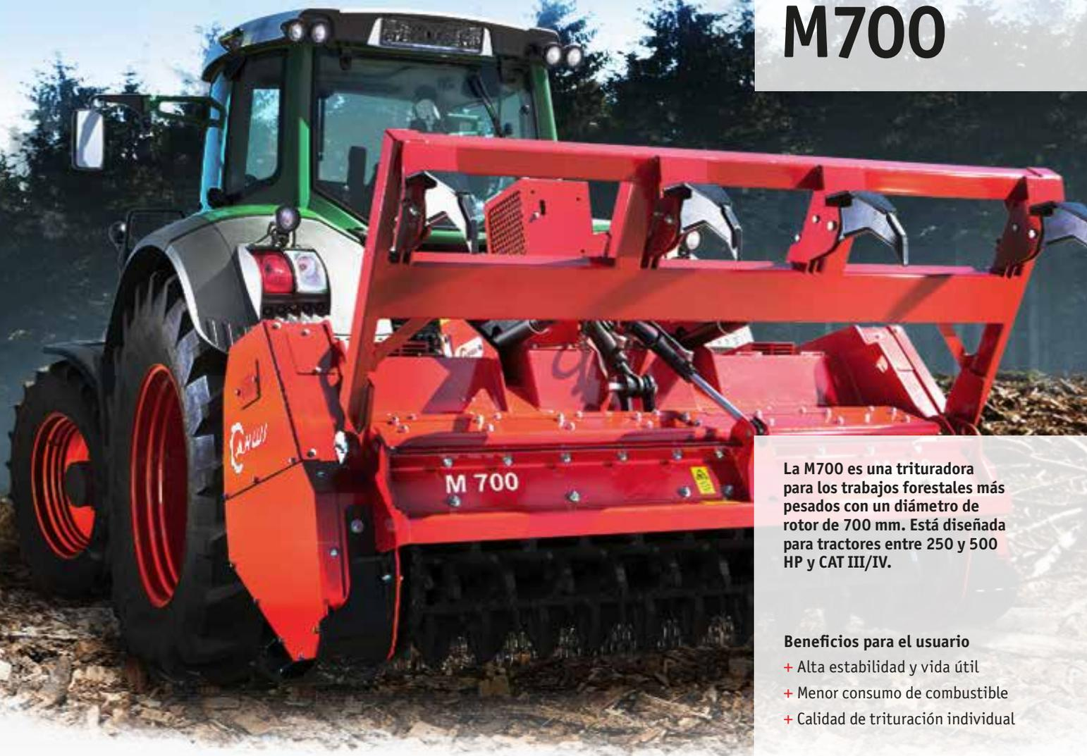
La M700 es una trituradora para los trabajos forestales más pesados con un diámetro de rotor de 700 mm. Está diseñada para tractores entre 250 y 500 HP y CAT III/IV.
