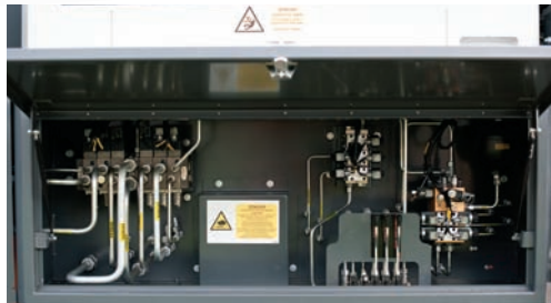
Tuberías de acero para una mejor disipación del calor
