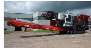
Dispositivo hidráulico de elevación/bajada en el transportador principal para aumentar la holgura
